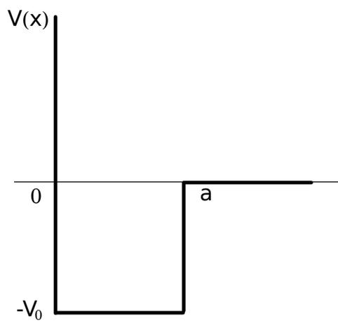
Abbildung 1: Endlicher Potentialtopf mit reflektierendem Rand.
