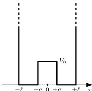
$$V(x) = \begin{cases} V_0 > 0 & \text{für } |x| < a \\ \infty & \text{für } |x| \geq \ell \\ 0 & \text{sonst} \end{cases}, \quad (*)$$
