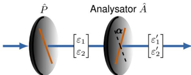
Lichtintensität hinter dem Analysator
